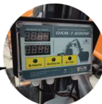
процессорный прибор с индикацией в кабине оператора
